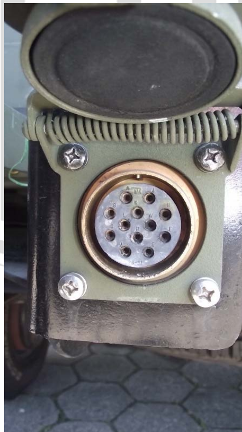
Figura 5A – Tomada militar com 12 pinos para reboque
